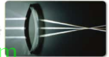
الشكل 9 تكسر العدسة الخبيبة الضوء إلى الداخل مع المحور البصري. أما شعاع الضوء الذي يمر عبر مركز العدسة مباشرة فلا يتكسر. حواف النقطه البؤرية للعدسة.
